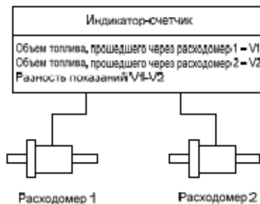
Рисунок 2.2. Функциональная схема подключения датчиков в режиме Счетчик
