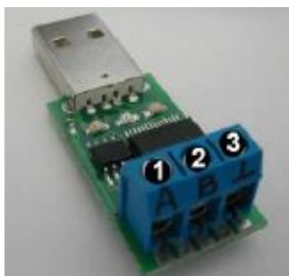
рис. 9 Внешний вид адаптера USB-RS485
